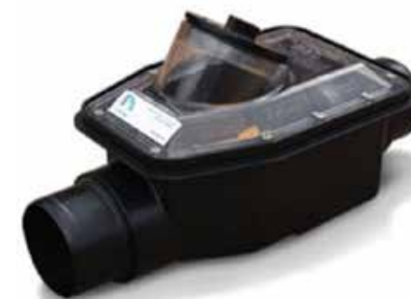
Zpětná klapka se instaluje na přípojku kanalizace a zabráňuje zpětnému vniknutí vody do všech domovních kanalizačních rozvodů
