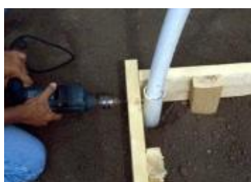
ساخت چوکات با پایپ پی وی سی پلاستیکی
