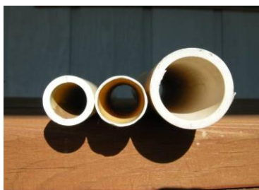
پایپ های پی وی سی پلاستیکی برای ساختن چوکات
