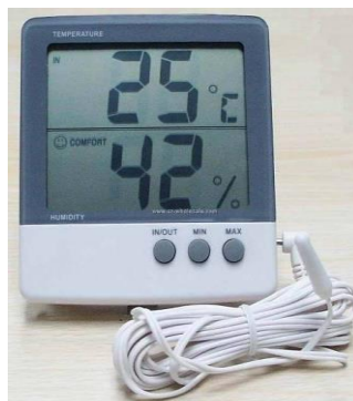
هایګرو متر هم د لندبل او همد تودوخي د بنودلو لپاره کارول کيږي
